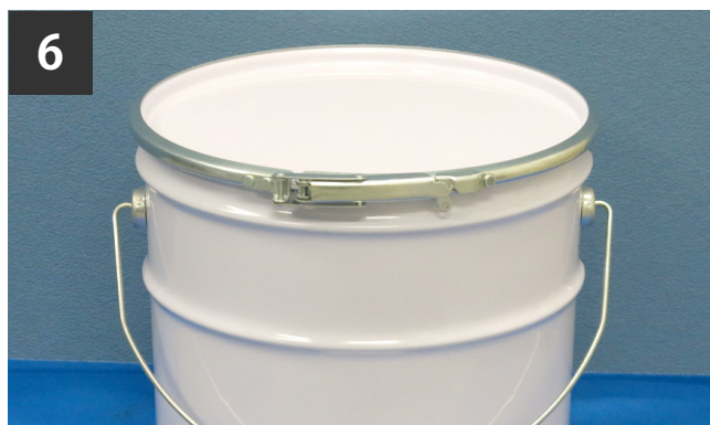
6 天板を押さえながらレバーを倒し、最後にロックをおろす
