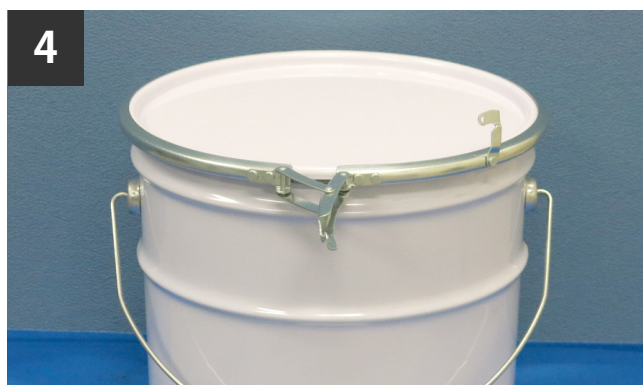
4 缶体のカールトップと天板をはさみこむように、レバーバンドをセットする
